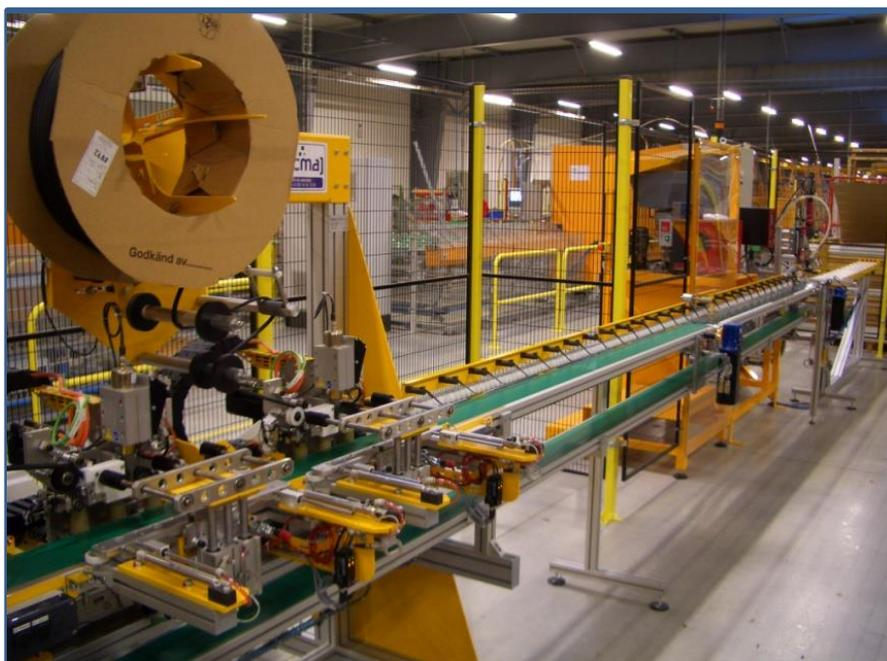
La machine permet une amélioration de la productivité par une automatisation de la pose et coupe de joints sur montants/poteaux et traverses.
